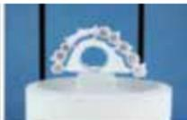
Posizionamento corretto sulla superficie di sinterizzazione
