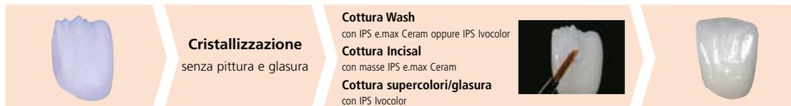
Cristallizzazione senza applicazione di masse. Cottura smalto con masse IPS e.max Ceram. Cottura supercolori/glasura con masse IPS Ivocolor.
