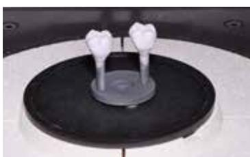
Posizionare in forno max. due unità IPS e.max CAD HT/MT/LT sul portaoggetti IPS e.max CAD Speed Crystallization Tray ied effettuare la cottura con la cottura di cristallizzazione Speed.
